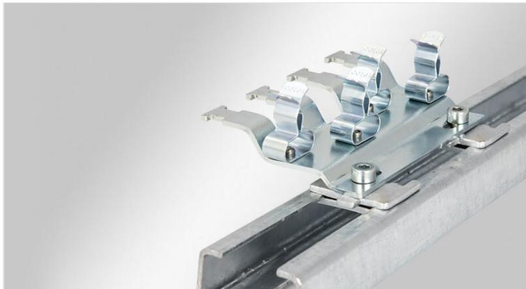
EMCローフットは、個々のケーブルシールドをアース電位に接続する場合に使用され、ケーブルを安全かつ簡単にシールドすることができます。様々な長さを用意しており、用途に応じて最大12個のSKL・MSKLシールドクランプを自由に装着できます。
